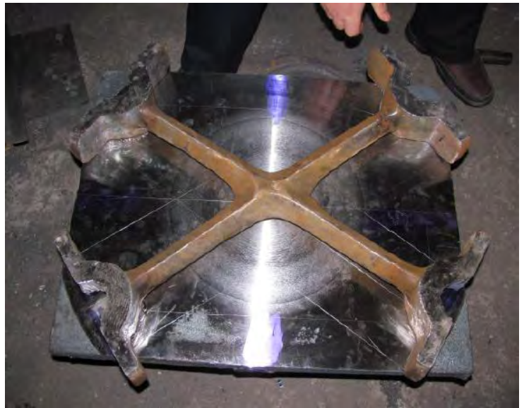
SAS Cable Separator
